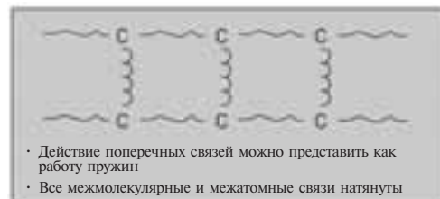
Рис. 2. Структура молекулы сшитого полимера
