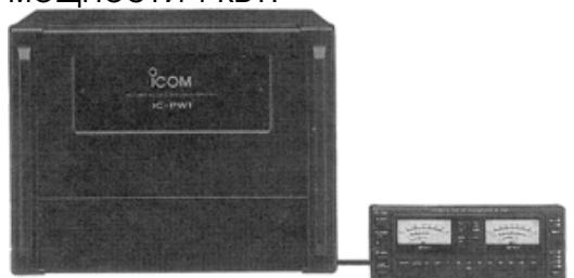
Линейный усилитель мощности на 1 кВт со встроенным антенным тюнером. Имеет возможность автоматической настройки и смены диапазона. Возможна дуплексная работа. Блок питания и устройство управления в отдельных корпусах.
