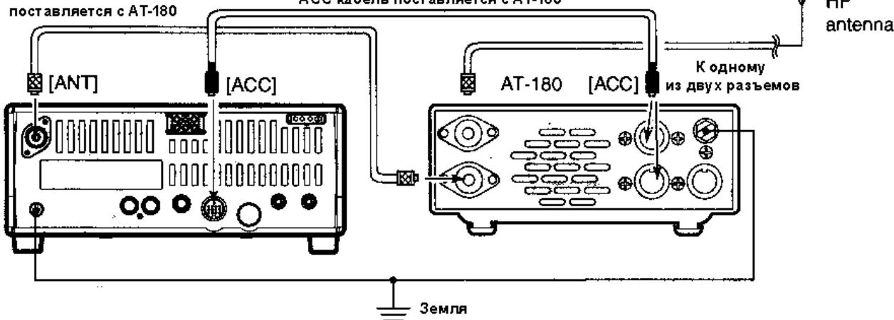
При подключении АТ-180 необходимо отключить питания трансивера, в противном случае это может вызвать сбой центрального процессора и АТ-180 может работать не корректно.
