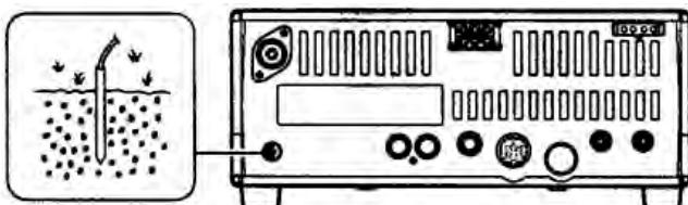
**⚠ ПРЕДУПРЕЖДЕНИЕ! НИКОГДА не подключайте заземление [GND] к газовой или электрической опоре, иначе это может вызвать взрыв или поражение током.**
