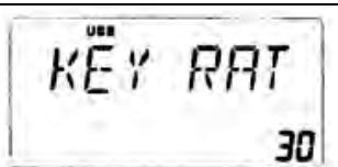
**• Частота тона для RTTY**
