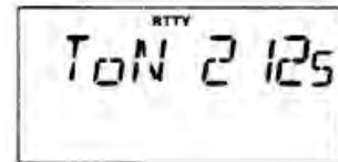
Частота логической «1» установлена на 2125 Гц. Допускается ее изменение на 2125, 1615 и 1275 Гц.
