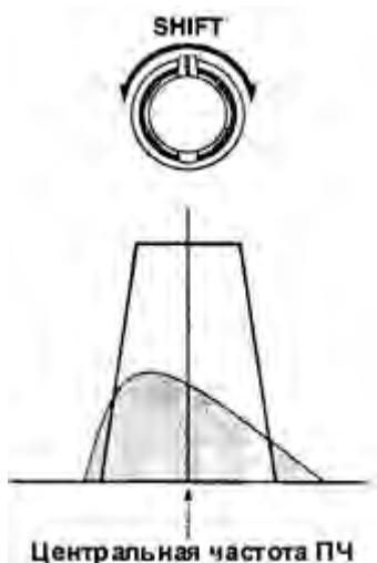
Срезание нижней части полосы пропускания
