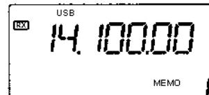
Измененная частота (14.123 МГц) не отобразилась. Вместо нее отображается частота, сохраненная в канале памяти (14.100 МГц).
