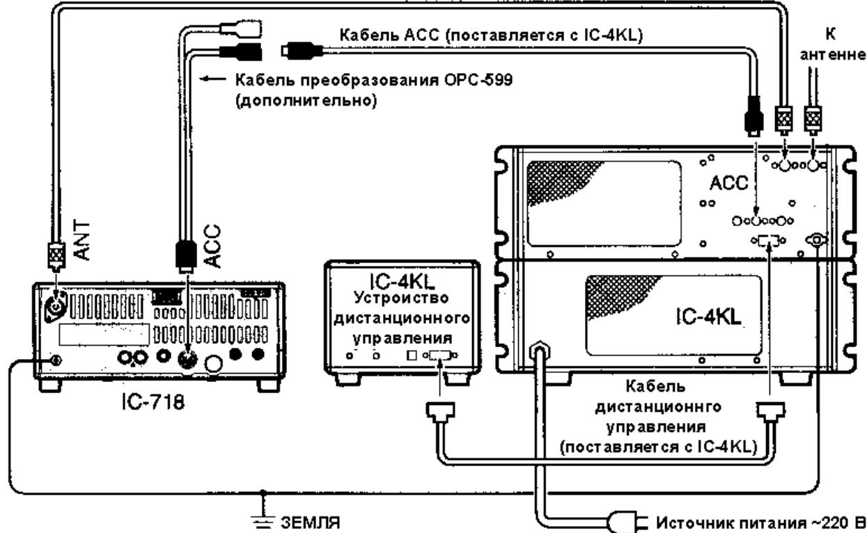
**ПОДКЛЮЧЕНИЕ УСИЛИТЕЛЕЙ МОЩНОСТИ ДРУГИХ ПРОИЗВОДИТЕЛЕЙ****⚠ ПРЕДУПРЕЖДЕНИЕ**
