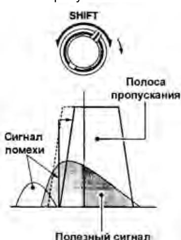
Срезание верхней части полосы пропускания
