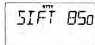
Разнос частот при RTTY установлен на 850 Гц. Допускаются значения 850, 425, 200 и 170 Гц.
