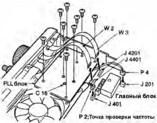
Подключите частотометр к разъему P2 и установите частоту 64.00000 МГц, используя регулятор C16.
