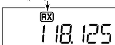
Если задать слишком высокий порог срабатывания шумоподавителя (установить большой номер), он может не открыться при приходе слабого сигнала. При приёме слабых сигналов снижайте порог срабатывания шумоподавителя (выбирайте число поменьше).
