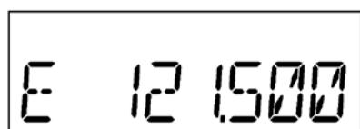
Рядом с аварийной частотой загорается её символ "E".
