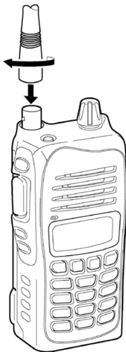
Вставьте прилагаемую антенну в антенный разъём и навинтите её на него, как показано слева.
