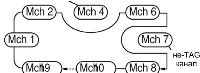
Многократное сканирование выбранного банка памяти – всех помеченных в нём каналов. Используется для проверки активности на наиболее часто используемых каналах с пропуском обычно всегда занятых каналов, например, частот башни управления.
