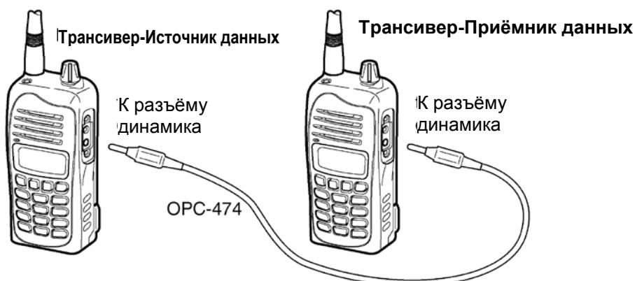
② При нажатой и удерживаемой нажатой кнопке **[MR]** ручкой **[VOL]** включите питание, чтобы войти в режим клонирования (только у трансивера-источника данных).
