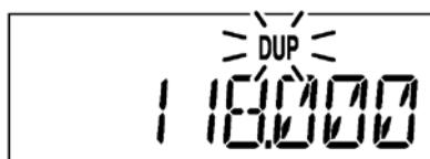
При установке частоты передачи индикатор "DUP" мигает.
