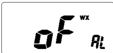
Погодное предупреждение выключено "oF" (заводская установка)
