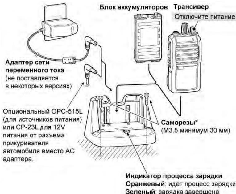
(\*) Саморезы приобретаются отдельно. Компания ICOM рекомендует закрепить зарядное устройство на горизонтальной твердой поверхности.
