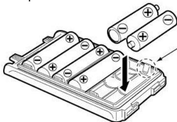
**Будьте осторожны!** Отрицательные контакты в корпусе батарей слегка выступают из корпуса, так что соблюдайте осторожность при установке батарей и не нанесите травмы вашим пальцам.
