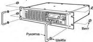
(2) После завершения процедуры установки репитер должен выглядеть следующим образом.
