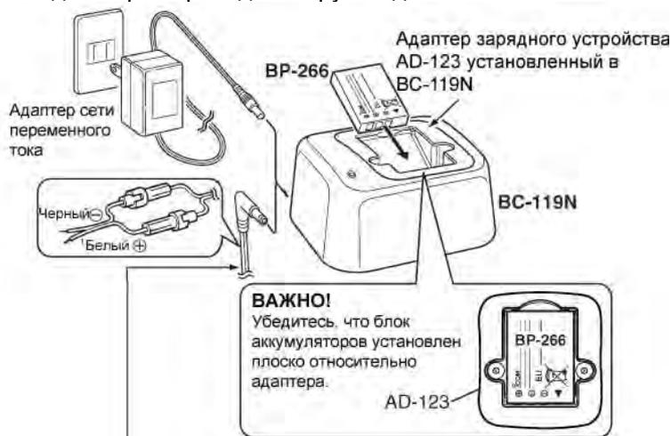
Вместо адаптера сети переменного тока может быть использован кабель OPC-515L (для источника питания 13.8V DC) или CP-23L (адаптер разъема прикуривателя автомобиля)
