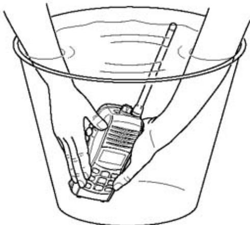
Рекомендуется обмыть трансивер под струей пресной воды после попадания на его поверхность морской воды.
