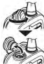
① Для вскрытия крышки [DC] разъема, поверните ее против часовой стрелки.
