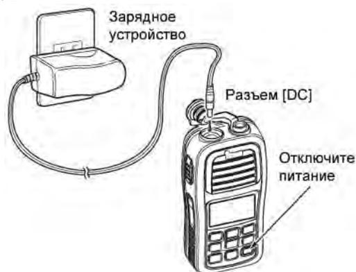
**ПРИМ.** Если индикаторы “
