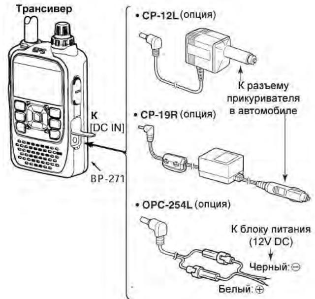
**ПРИМ.** При использовании внешнего источника DC питания возможно использование максимального уровня выходной мощности (примерно) 5 Вт. Однако, если напряжение внешнего источника питания достигает 14V, то встроенная схема защиты снижает уровень выходной мощности до 2.5 Вт.
